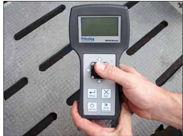
Handbedienteil zur Einstellung der Parameter und zum manuellen Fahren des PriBot.
