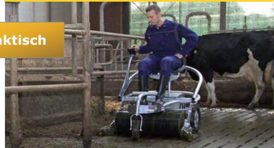
Äußerst wendig und sehr schnell dank der kompakten Bauweise mit unabhängig voneinander angetriebenen Hinterrädern (Zero-Turn).
