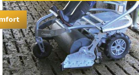
Mit Fußbedienung zum mühelosen Anheben von Walze und hinterem Schieber. Überwindet mühelos Schwellen und ansteigende Flächen.
